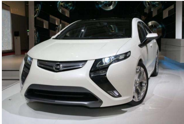
Fig.85 - Opel Ampera, un esempio di ibrido serie.
