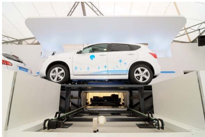
Fig.95 - Operazione di sostituzione automatica delle batterie.
