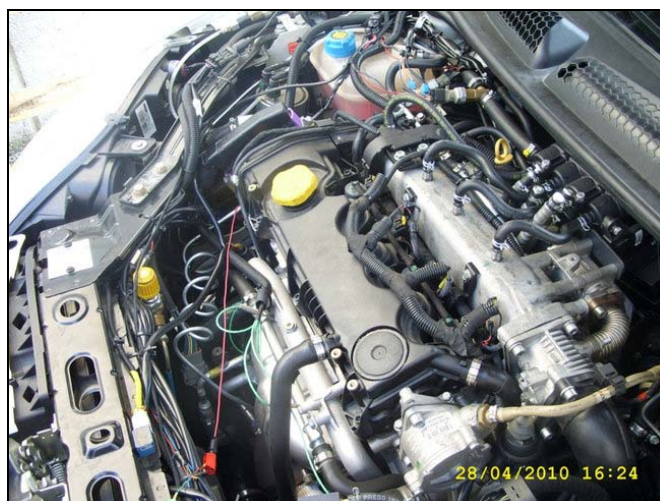
Fig.67 - Motore del prototipo bifuel Landi Metano/Gasolio; notare il rail di iniettori del Metano.
