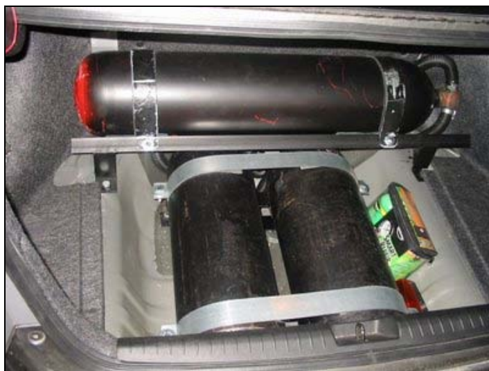
Fig.60 - Esempio di sistemazione di alcune bombole di Metano di un impianto aftermarket nel bagagliaio di un autoveicolo.
