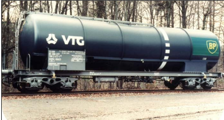
Fig.45 - Carro ferroviario da 120 m 3 per il trasporto di GPL.
