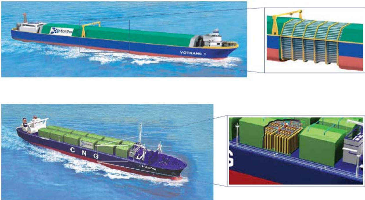
Fig.29 - Navi per il trasporto di CNG con tecnologia VOTRANS, a serbatoi orizzontali e verticali.
